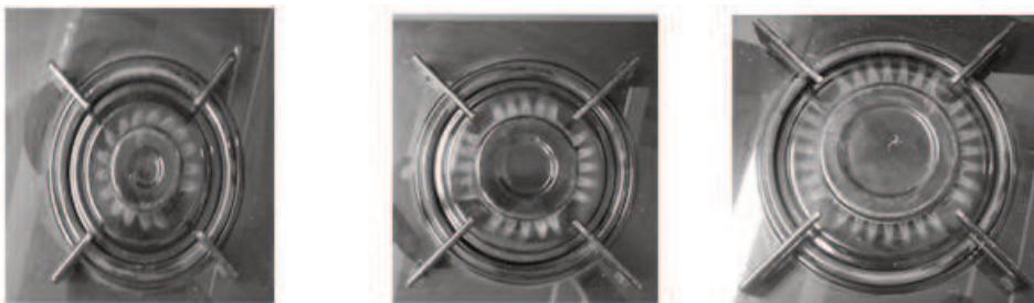
Rysunek 13. Korony płomieni palników przy dodatku 23% wodoru do gazu ziemnego. Kolejno (od lewej): palnik mały, palnik średni, palnik duży.
